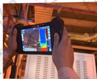
气体泄漏检测
